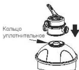
4. Подсоедините регулирующий клапан к верхнему баку, чтобы уплотнительное кольцо стало на место на кромке верхнего бака; убедитесь в том, что уплотнительное кольцо и кромка верхнего бака чистые, без зазубрин, разрывов, мусора или песка, а также, что вертикальная трубка втулки вставлена в основание регулирующего клапана.
